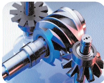
*Ведущий ротор и два затворных ротора с уплотняющими накладками в зацеплении*
